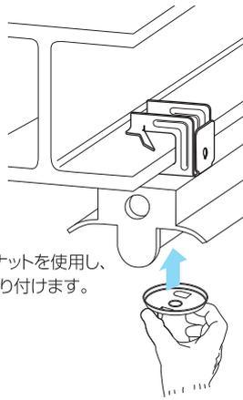
②チャンネル平ナットを使用し、照明器具等を取り付けます。
