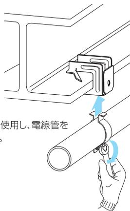
②UCクリップを使用し、電線管を取り付けます。
