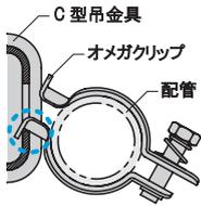
1. 配管にクリップを取付けて、下のツメを孔に引っ掛けます。
