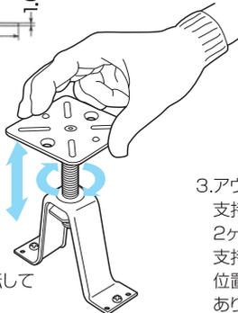
2. 支持ボルトを回転して高さ調整を行い、板ナットで固定します。
