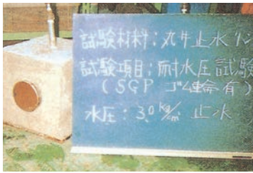
鉄管(SGP)水圧3kgf/cm 2 (0.3MPa)
